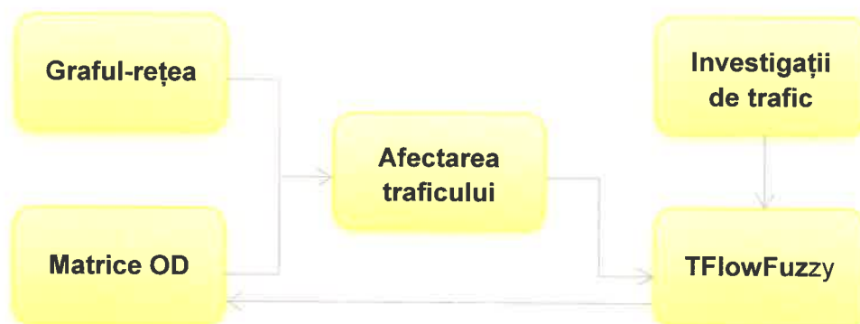
Figură 4-6 Schemă a logică a procesului de calibrare utilizat
