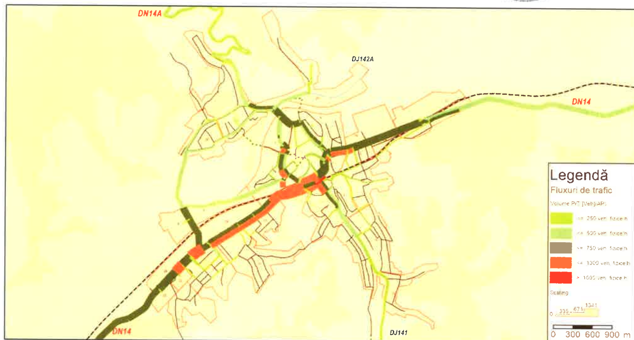
Figură 5-4 Afectarea traficului în scenariul de referință, total vehicule, anul 2020, AM peak
